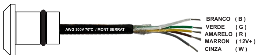
CONDUTOR ELÉTRICO DO BALIZADOR:
