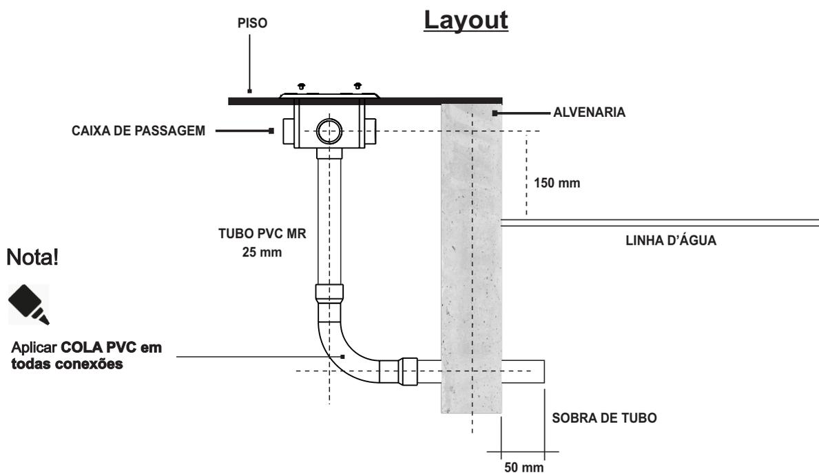
Após aplicar o revestimento na parede, é necessário cortar a sobra do tubo de modo que fique nivelado com o revestimento, criando uma superfície alinhada."
